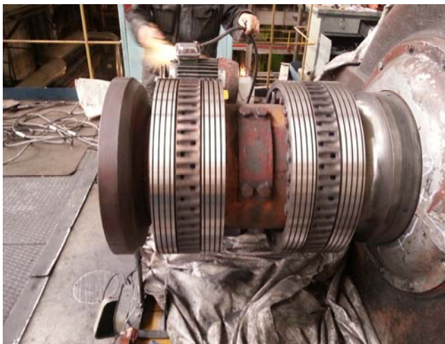
Рис.11. Проточка и шлифовка контактных колец
