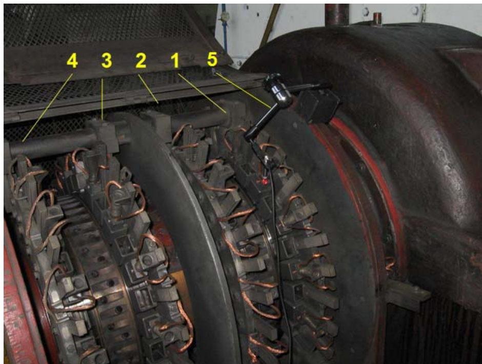
Рис.4. Проверка биения КК при помощи профилометра «CL-profiler»
