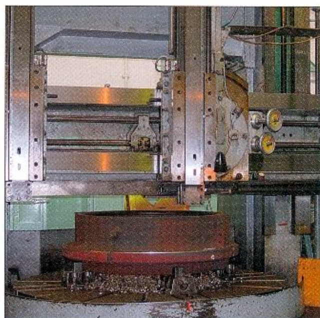
Рис. 4. Доработка обоймы диафрагм ЦВД
