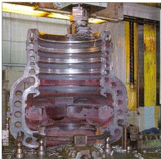
Рис. 3. Доработка внутреннего цилиндра ЦВД
