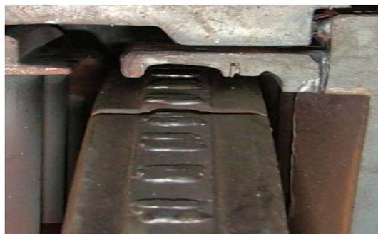
Рис.6. Надбандажное радиальное уплотнение проточной части ЦСД т/а К-200-130 после задеваний
