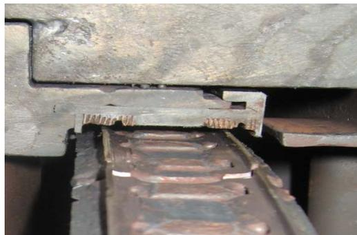
Рис.5. Надбандажное сотовое уплотнение проточной части ЦВД т/а К-200-130 после задеваний
