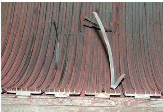
Рис.8. Концевое лабиринтное уплотнение ЦВД т/а К-200-130 после задеваний
