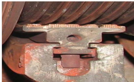
Рис.7. Концевое сотовое уплотнение ЦНД т/а Т-250/300-240 после 5 лет эксплуатации
